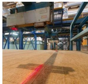
Толщиномер, встроенный в производственную линию
