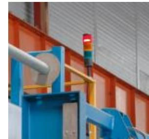
Сигнальные устройства на производственной линии
